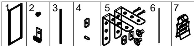
Модуль (1) с фиксатором нижним и винтом M5x6 с полукруглой головкой, шлиц (2). Стойка вертикальная (3) с фиксатором и винтом установочным (4). Комплект крепежа "Модуль-стол" (5). Заглушка профильная (6). Скоба пружинная (7). Количество элементов определяется дизайн-проектом.
